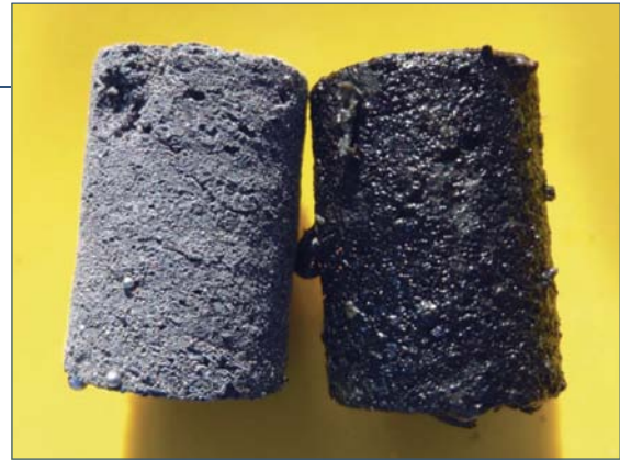
Fig. 4 - Corpos de prova sem deposição (à esq.) e com deposição de biofilme
